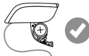
3. Insira a nova bateria com o sinal de positivo (+) corretamente posicionado no compartimento da bateria. Não insira-a diretamente no aparelho auditivo.
