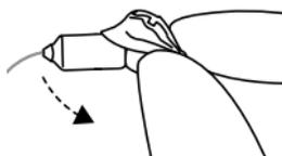
3. Verifique se a oliva está montada com segurança levantando cuidadosamente sua parte inferior e verificando se o colar cobre completamente a extremidade rugosa do receptor.
